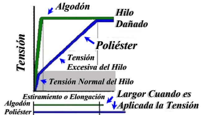
**Figura 4. Elongación o Estiramiento cuando Tensión es Aplicada**
